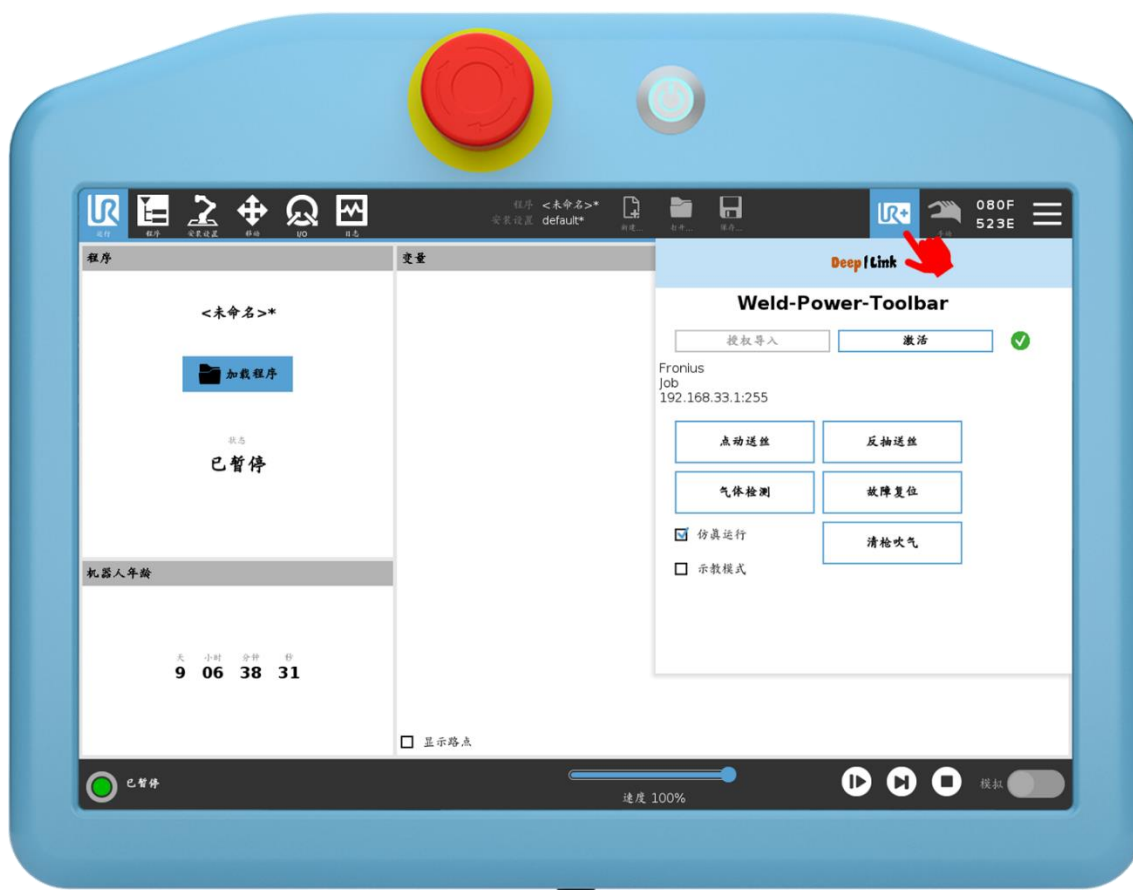
Figure 55 Toolbar 工具栏界面, 从 1.0.3-Build026 版本起 在工具栏菜单中添加了点焊按钮, 对于所有焊机品牌点焊的参数 Job 号固定为 22.
