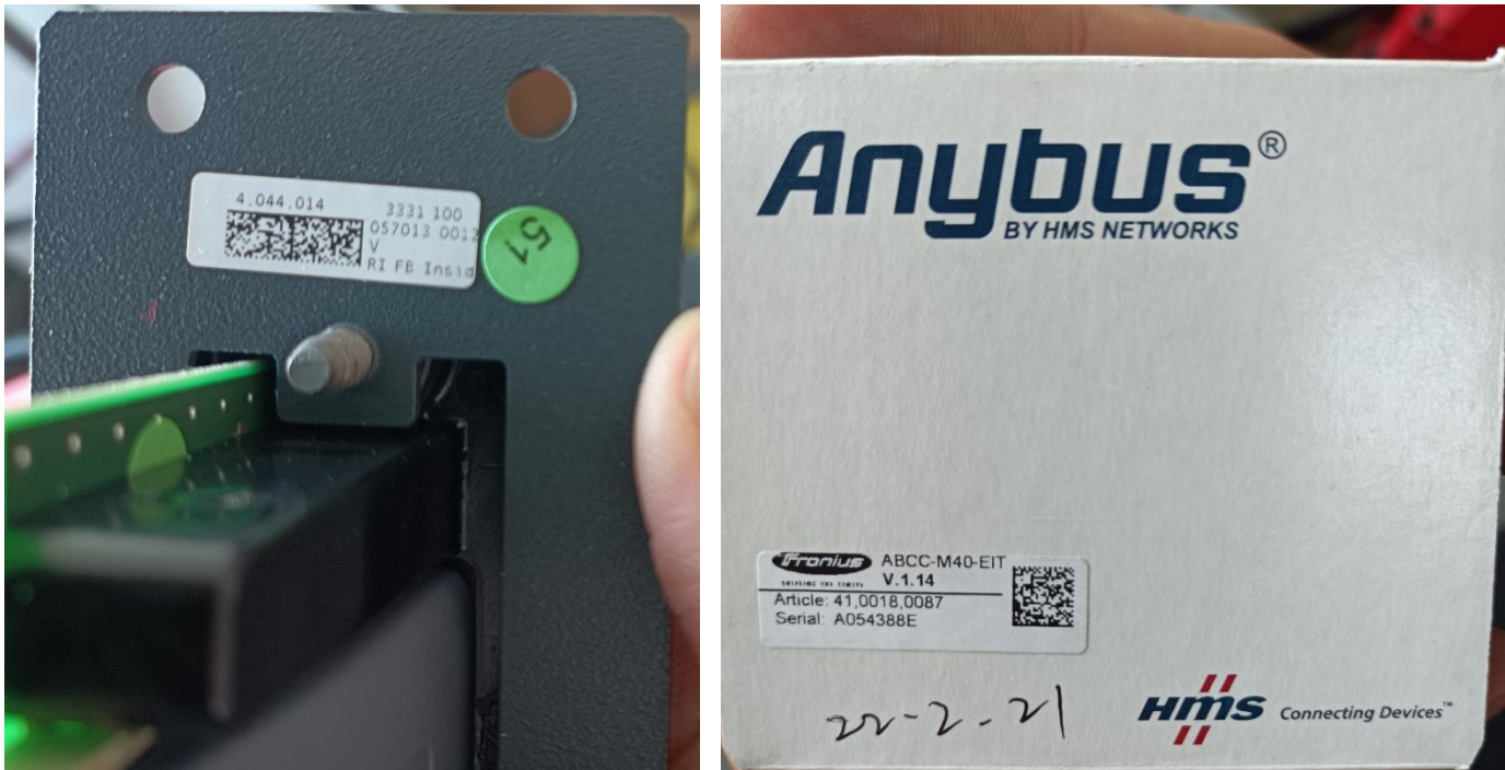
Figure 41 Fronius 通讯硬件: 4.044.014 为FB 模块 和 41.0018.0087 Modbus 模块.
