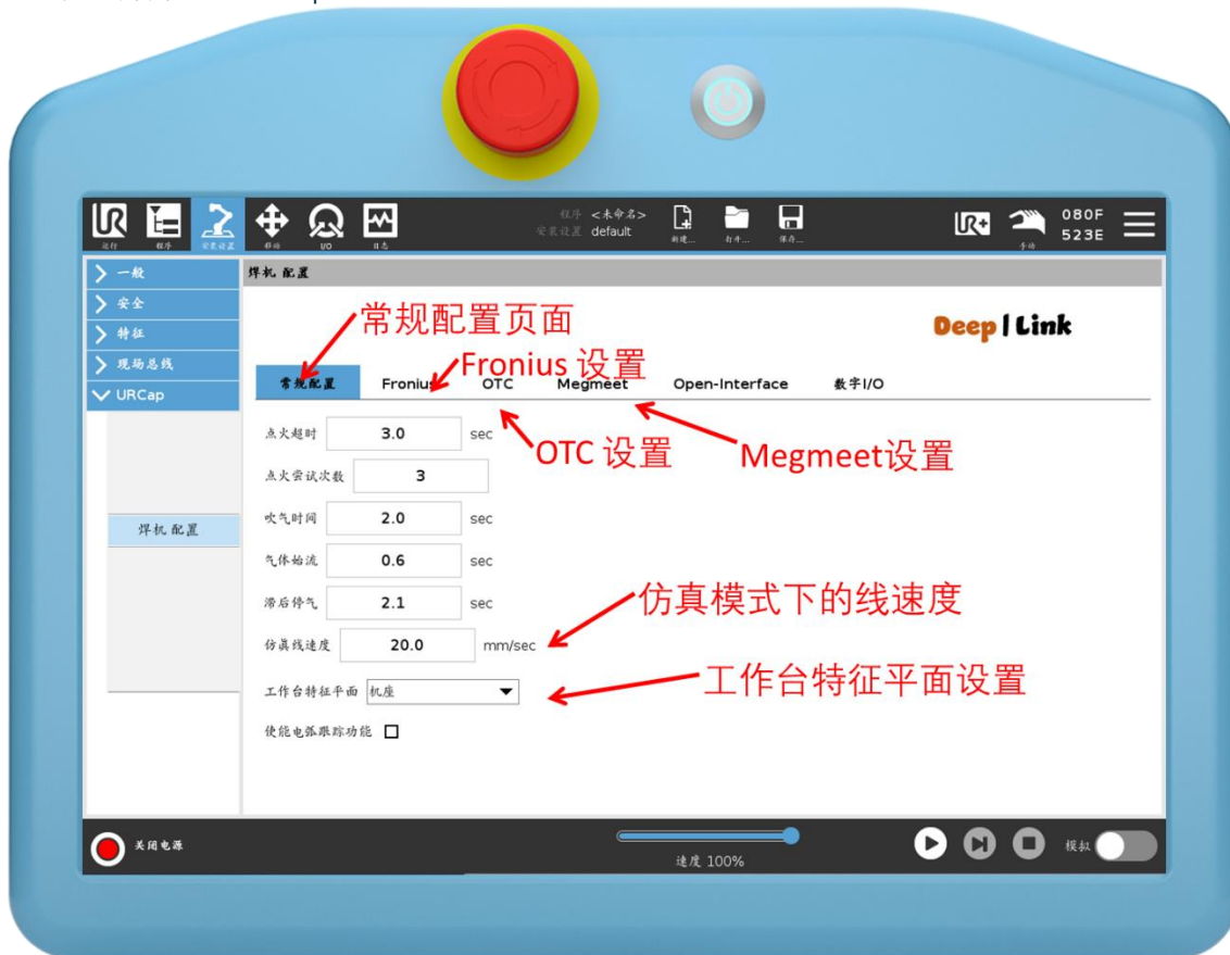
Figure 40 安装节点配置
