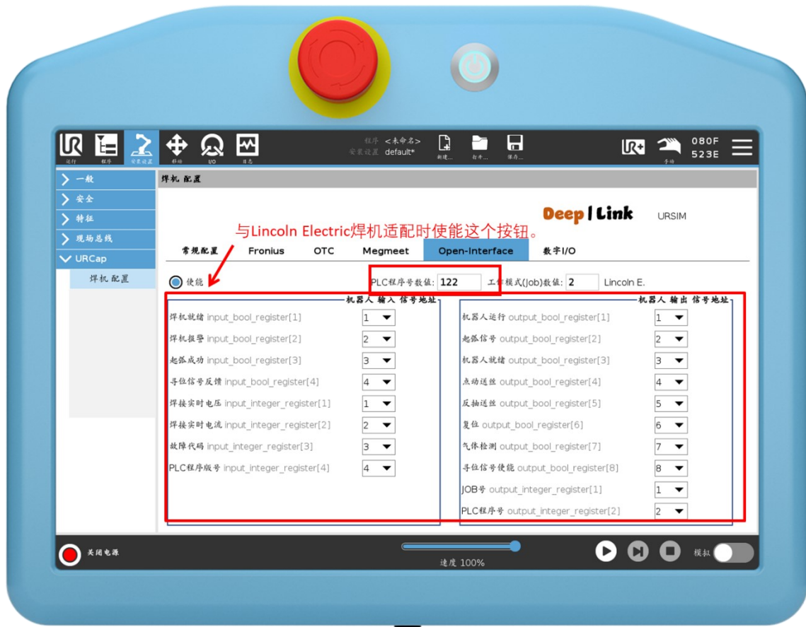
Figure 49 Lincoln Electric 焊机配置界面，默认 Lincoln Electric 焊机 IP 地址为 192.168.0.12.
