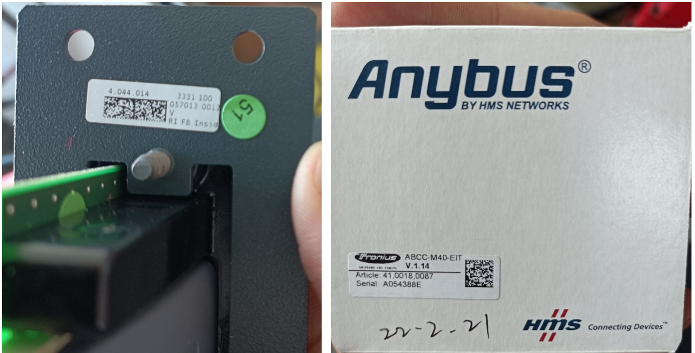
Figure 44 Fronius 通讯硬件: 4.044.014 为FB 模块 和 41.0018.0087 Modbus 模块.
