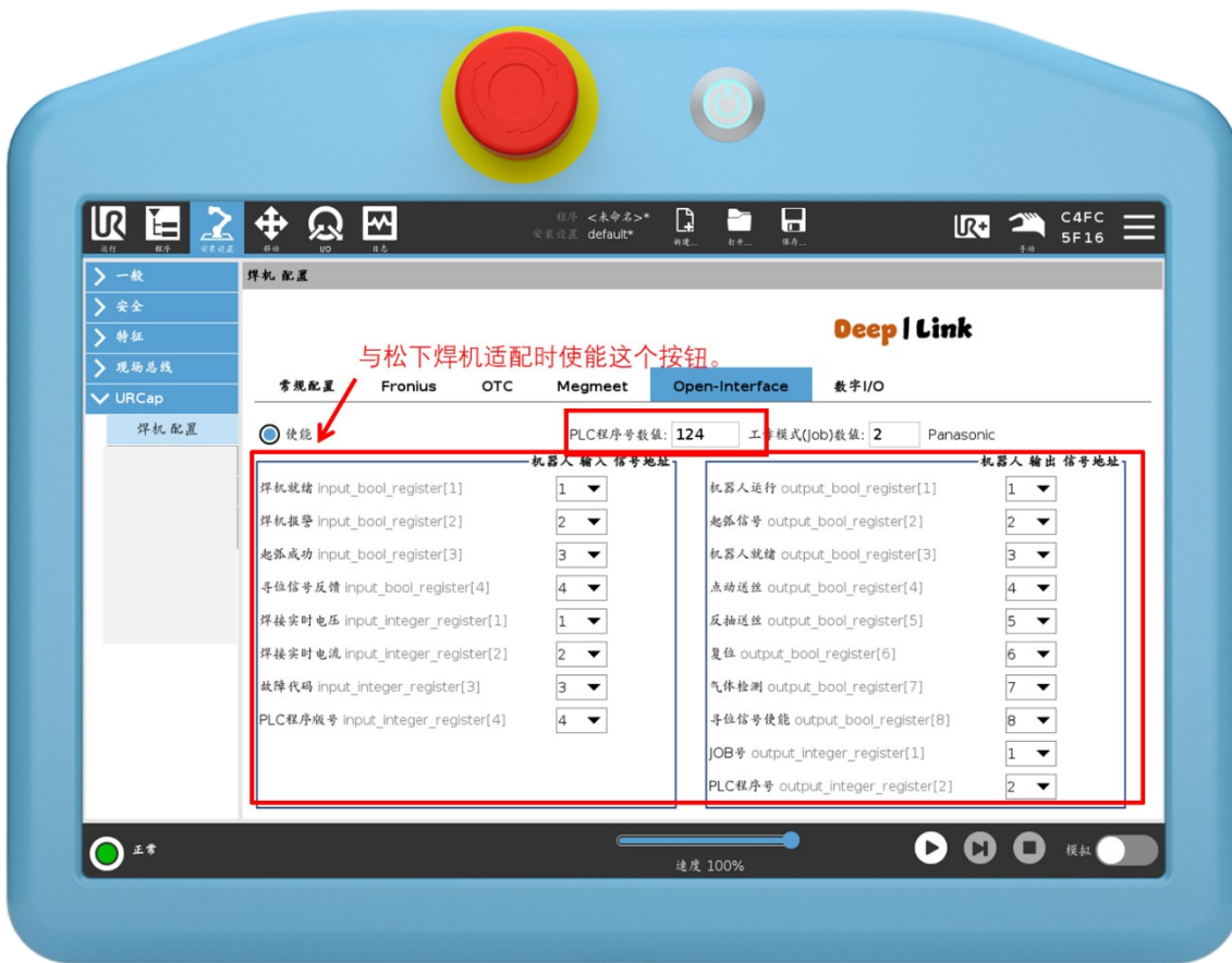
Figure 51 松下焊机配置界面，默认松下焊机 IP 地址为 192.168.0.6。工作模式 4 (Job)。
