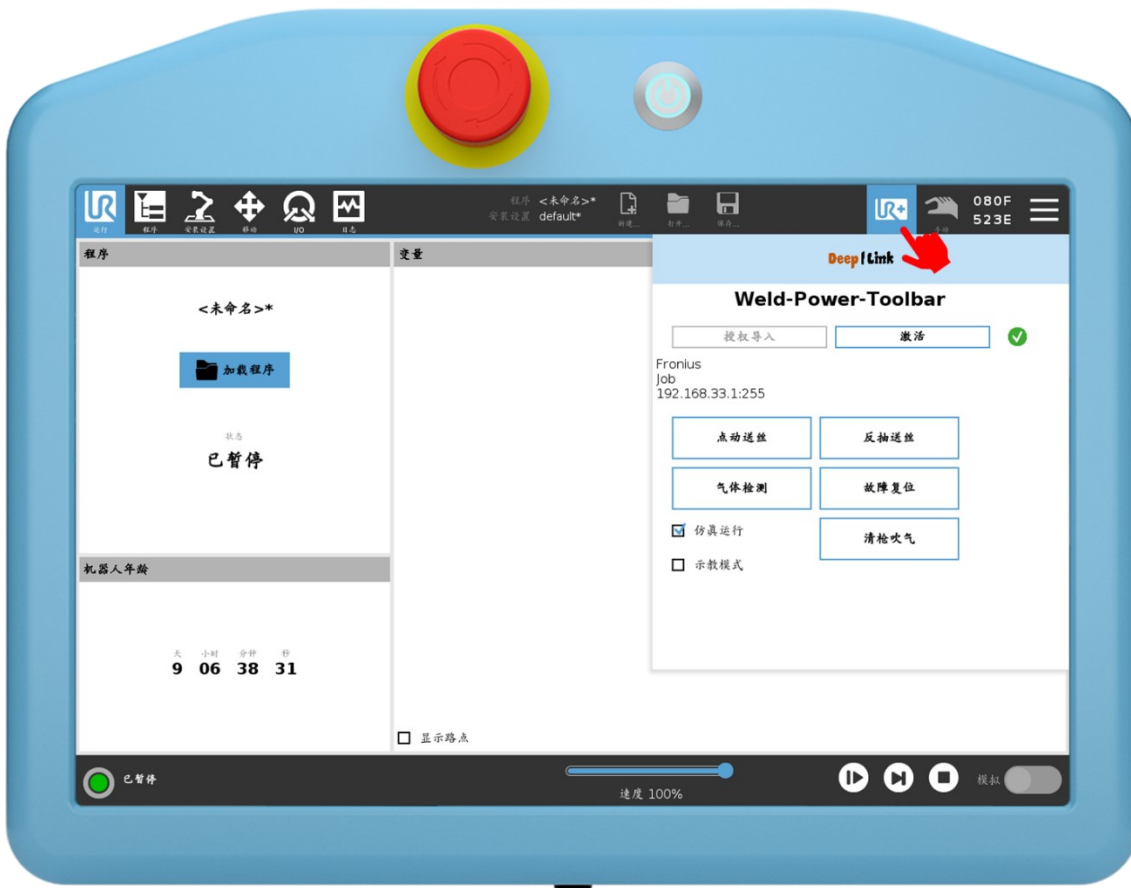
Figure 61 Toolbar 工具栏界面, 从 1.0.3-Build026 版本起 在工具栏菜单中添加了点焊按钮, 对于所有焊机品牌点焊的参数 Job 号固定为22.
