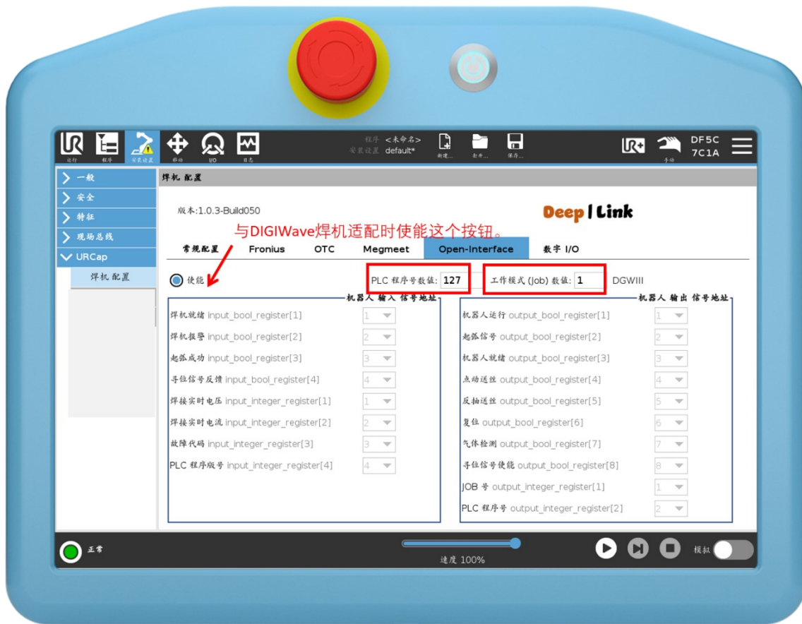
Figure 53 DIGIWave 焊机配置界面，默认 DIGIWave 焊机 IP 地址为 192.168.0.7 工作模式为 1 (Job).
