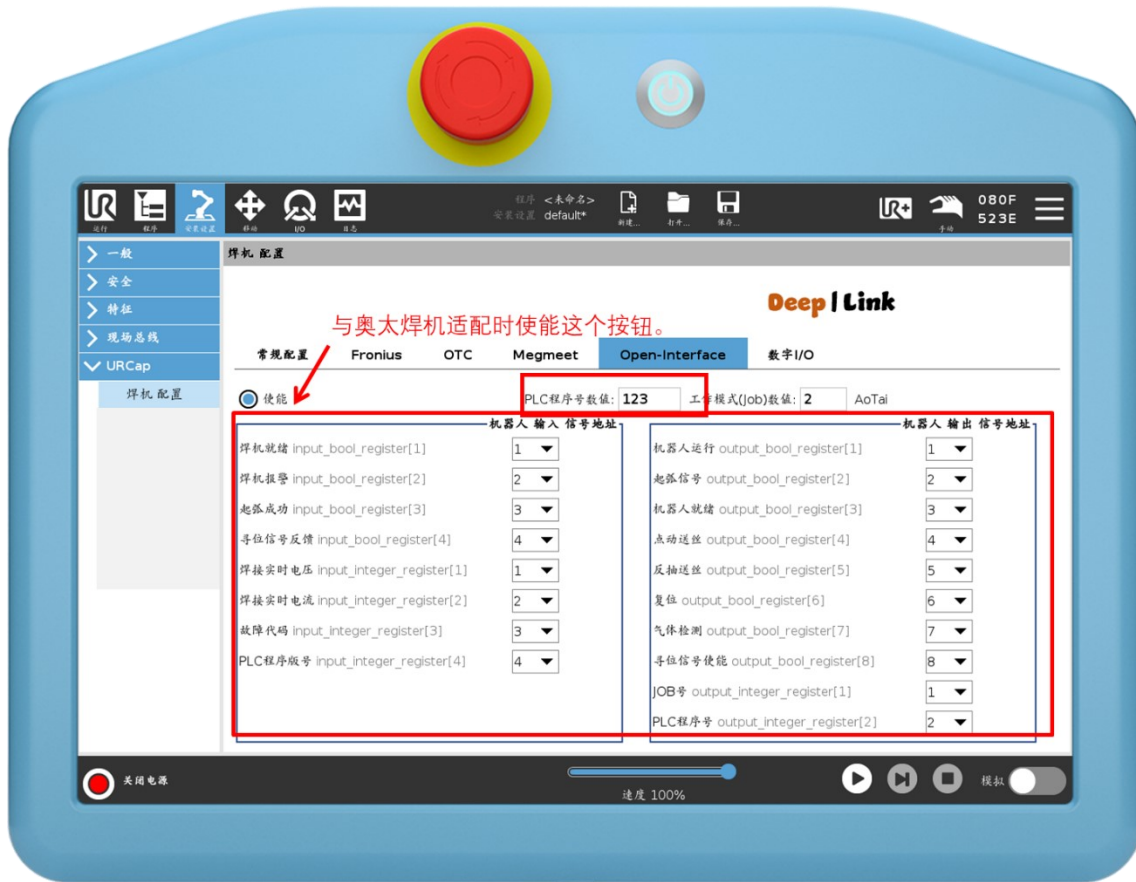
Figure 50 奥太焊机配置界面，默认奥太焊机 IP 地址为 192.168.0.8, 工作模式 2 (Job).
