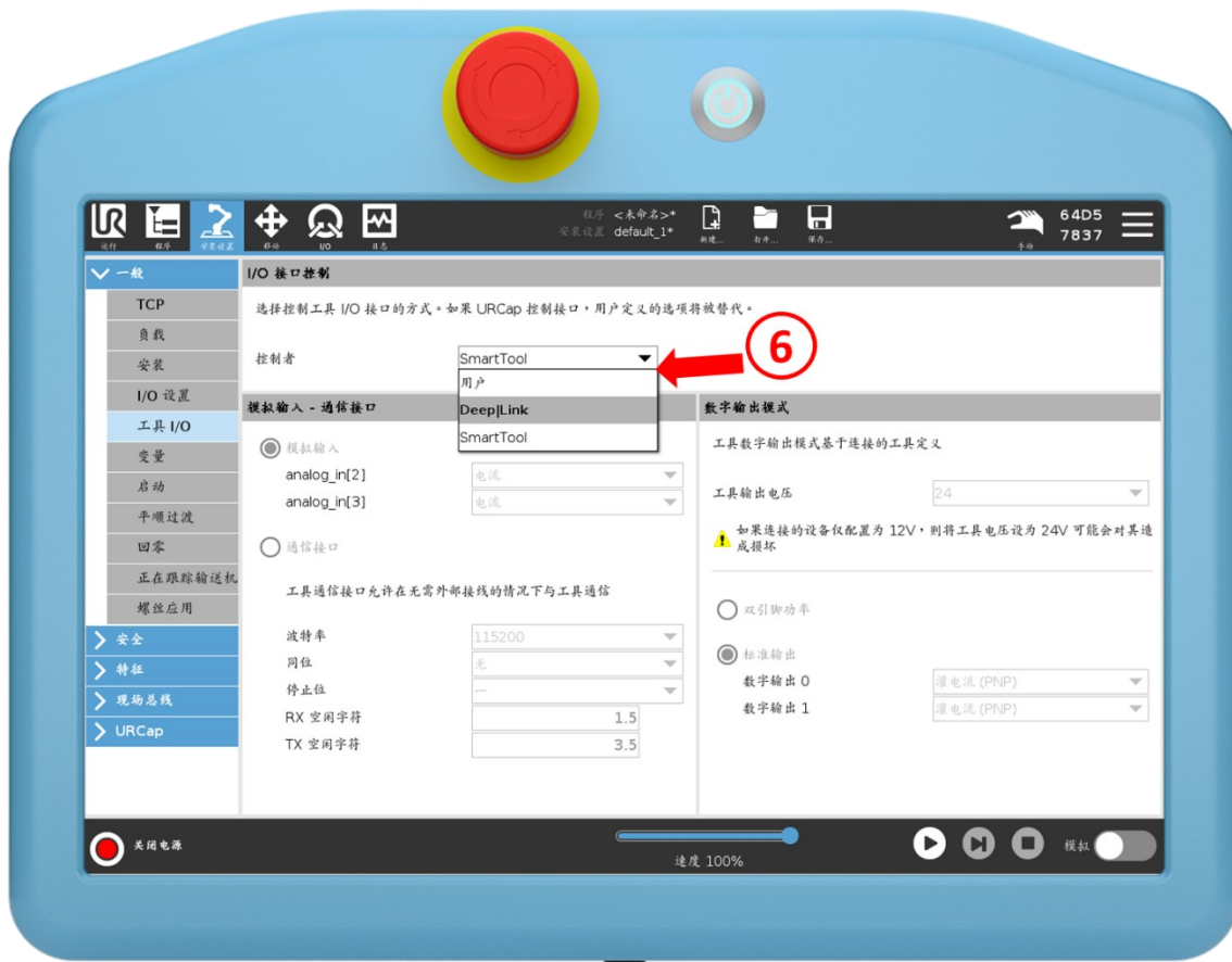
Figure 26 安装第5步：工具IO设置。
