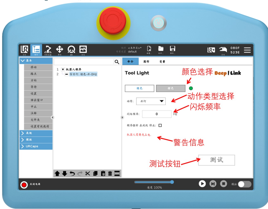
Figure 37 工具信号灯编程页面，闪烁频率0Hz 意味着LED 灯常亮，当前有2 中颜色可选【绿色、橙色】，有2 中动作命令可选【开灯、熄灯】。
