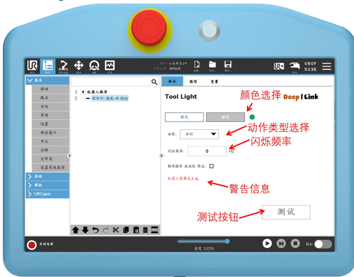
Figure 33 工具信号灯编程页面，闪烁频率0Hz 意味着LED 灯常亮，当前有2 中颜色可选【绿色、橙色】，有2 中动作命令可选【开灯、熄灯】。
